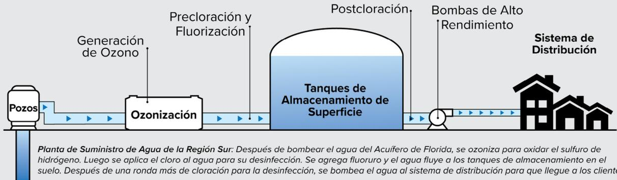
*Planta de Suministro de Agua de la Región Sur: Después de bombear el agua del Acuífero de Florida, se ozoniza para oxidar el sulfuro de hidrógeno. Luego se aplica el cloro al agua para su desinfección. Se agrega fluoruro y el agua fluye a los tanques de almacenamiento en el suelo. Después de una ronda más de cloración para la desinfección, se bombea el agua al sistema de distribución para que llegue a los clientes.*
